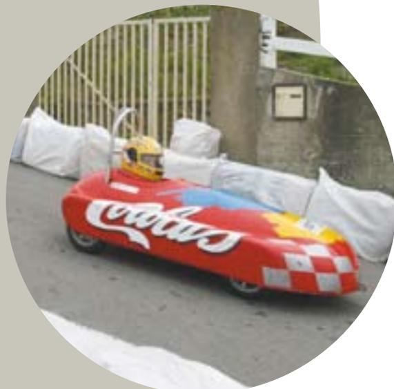
La caisse à savon, c'est une coque en fibre de verre, des freins à disques et le brio du pilote.
